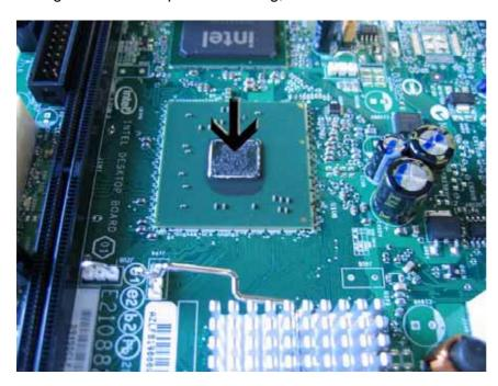
Entfernen Sie die Schutzfolie des neuen Kühlkörpers und platzieren ihn mit leichtem Druck auf den Chipsatz. Achten Sie dabei auf die Position der Nut, in der die Halteklemme platziert wird. Die Kühlrippenöffnungen müssen wie auf dem Bild gezeigt in Richtung passiven CPU Kühler zeigen.
