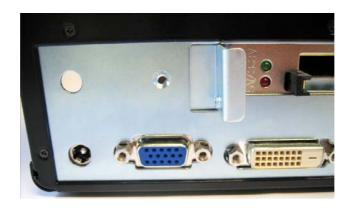
6. Verschrauben Sie den Halterungswinkel nun von außen mit der I/O Blende
