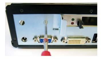
7. Anschließend verschrauben Sie die PCI Card mit dem Halterungswinkel
