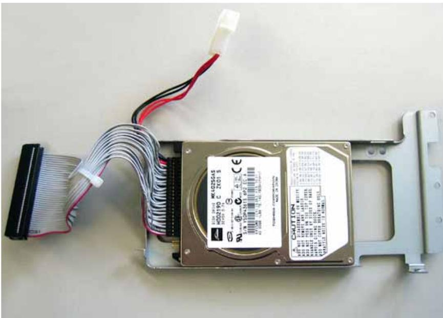
Danach steckt man das IDE Kabel in den IDE Steckplatz und schließt den Molex-Stecker an das Stromkabel an:
