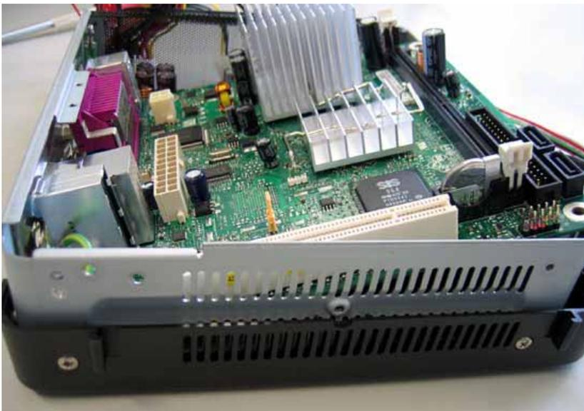
Es muss darauf geachtet werden, dass die Ports (Parallel und LAN) in die Backpanelblende passen, danach kann man das Mainboard vorsichtig in das Gehäuse drücken:
