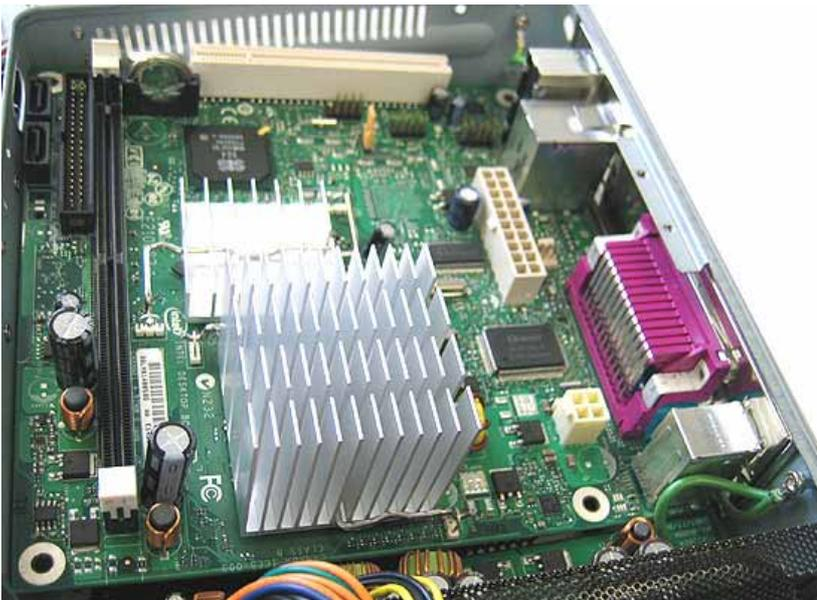
Danach schraubt man das Mainboard fest. Das mitgelieferte ATX Kabel mit P4 Anschluss wird eingesteckt und entsprechend verlegt:
