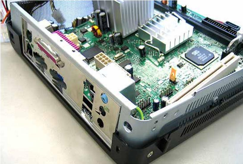
Es ist eng, daher kann es gut sein, dass das Mainboard mit der Ecke an der Gehäusewand streift:
