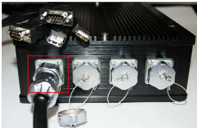
Der zweite Anschluss von Links ist der Ethernet – Anschluss.
