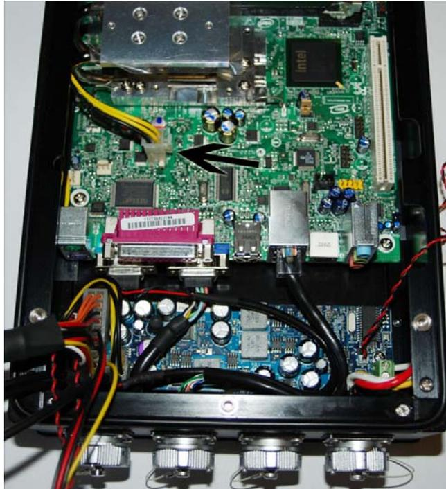
13. Nun wird der 20polige ATX Stecker ebenfalls vom Netzteil mit dem Mainboard verbunden. Setzen Sie den ATX Stecker ganz rechts auf dem Mainboard ATX Connector an. Links bleiben nun 4 Steckplätze frei, die für die Funktion des Mainboards nicht notwendig sind.
