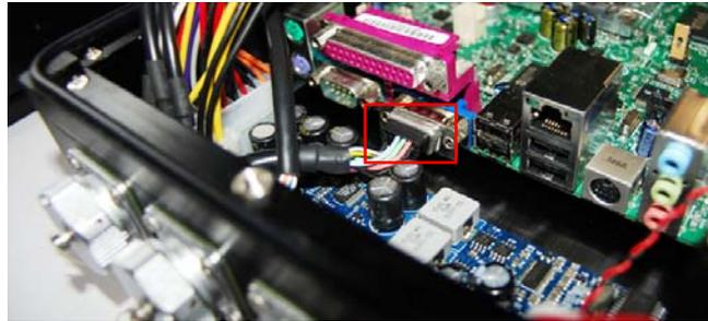
10. Verbinden Sie nun den Ethernet Anschluss des Gehäuses mit der Netzwerkbuchse an der Slotblende
