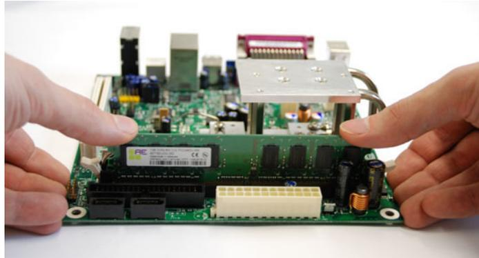
7. Setzen Sie nun das Mainboard wie auf dem Bild gezeigt in das Gehäuse ein und befestigen Sie dieses mit den im Lieferumfang enthaltenen Schrauben.
