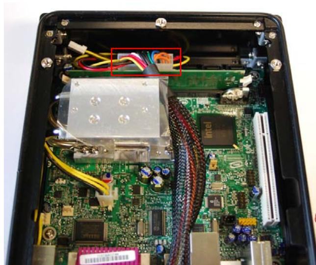
14. Verbinden Sie nun das am Gehäuse angebrachte USB Kabel mit der Mainboard Schnittstelle
