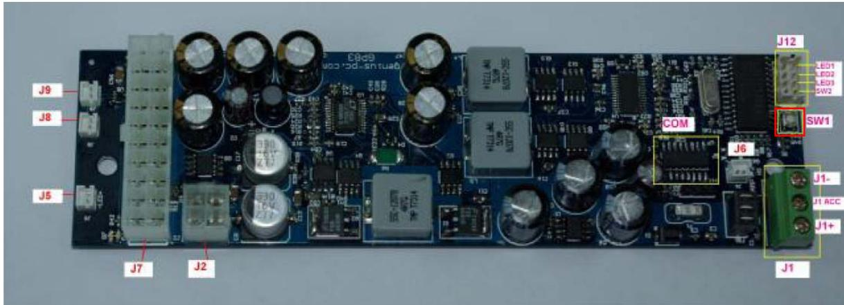
Die Einstellungen werden an dem auf dem Netzteil angebrachten Taster vorgenommen (Hier mit SW1 bezeichnet). Die drei LED's daneben zeigen die Jumbereinstellung an. Drücken Sie solange auf den Taster bis die gewünschte LED Kombination (siehe unten) angezeigt wird.
