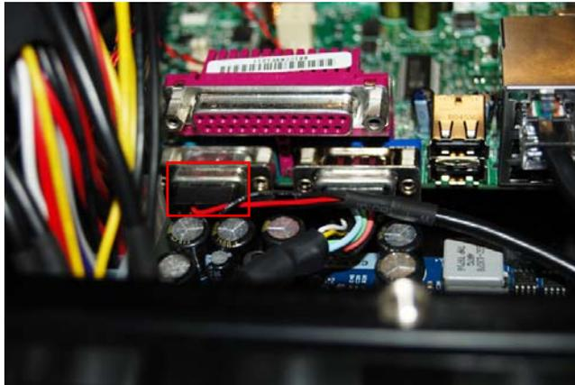
12. Als nächster Schritt wird das P4 Kabel vom Netzteil auf dem Mainboard angebracht
