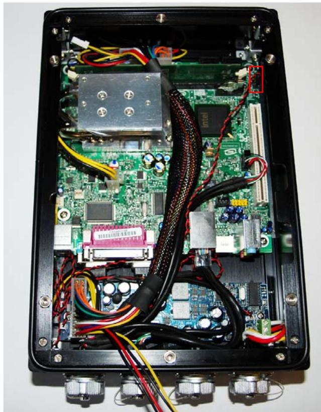
16. Verbinden Sie nun das SATA Datenkabel mit dem SATA Connector auf dem Mainboard
