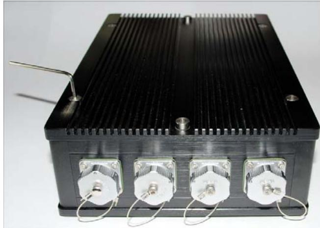
Achten Sie darauf dass keine Kabel zwischen Gehäuse und Deckel rutschen.
