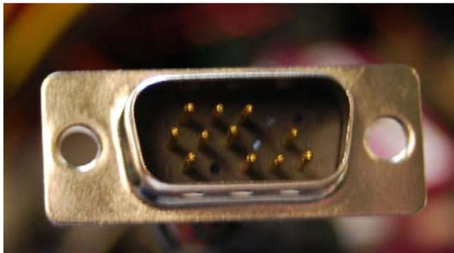
Stecken Sie den am Gehäuse angebrachten VGA Stecker auf den VGA Anschluss an der Slotblende.
