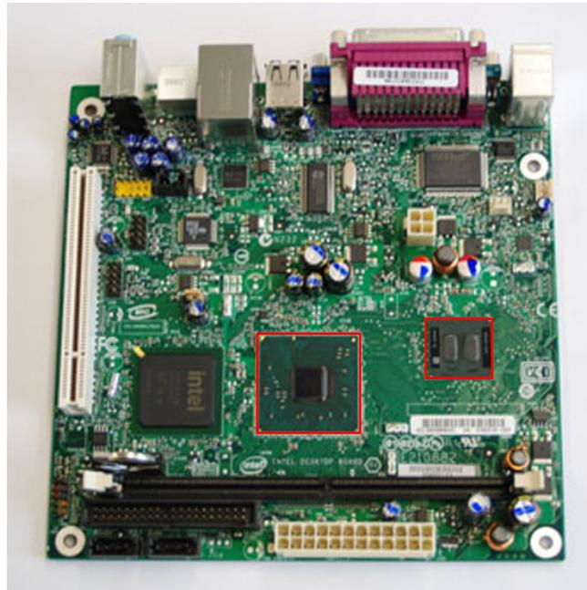
3. Tragen Sie die mitgelieferte Wärmeleitpaste in einer dünnen Schicht auf den Grafikchipsatz und die CPU auf
